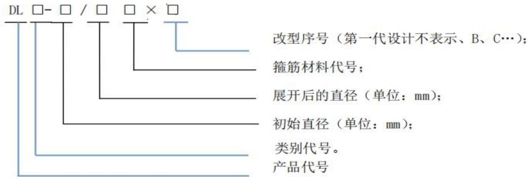
示例：第一代设计，采用钢丝绳作为箍筋材料，直径可由 200mm 展开到 350mm 的钢筋笼表示为 DL MBL-200/350S。
